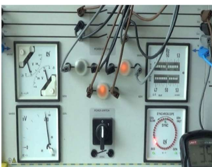
Slika 6.59 Sinkronizacijske lampe se kreću od 6 sati prema 12 sati – pada nul voltmetar prema nuli
