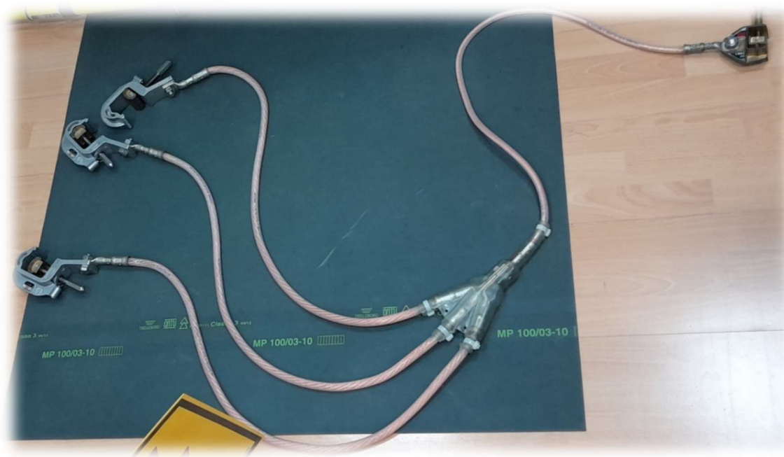
Slika 2.7 Naprava za uzemljivanje i kratko spajanje PAUK (engl. spider)
