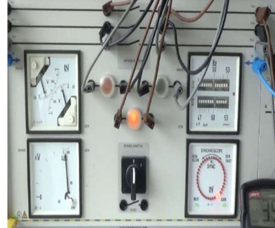
Slika 6.58 Sinkronizacijske lampe se kreću od 2 sata prema 6 sati – raste nul voltmetar prema maksimumu
