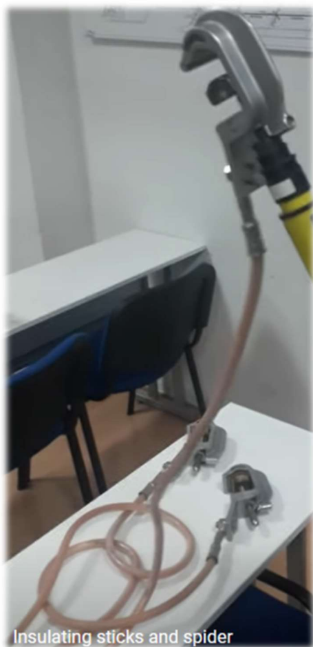
Slika 2.10. Izolacijski teleskopski nastavci za postavljanje pauka
