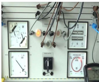
Slika 6.58 Sinkronizacijske lampe se kreću od 2 sata prema 6 sati – raste nul voltmetar prema maksimumu
