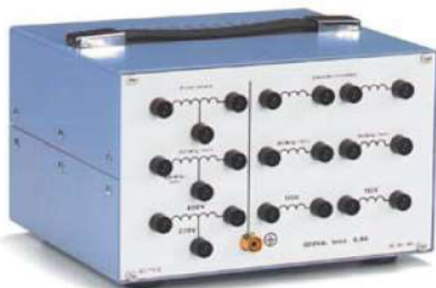
Slika 1.8. Trofazni transformator na kojem se može ostvariti bilo koja grupa spoja
