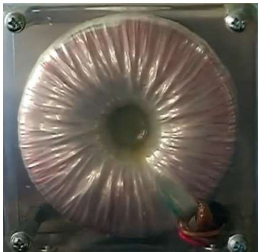
Slika 4.4.1. Oblik jezgre toroidnog transformatora (transformator T2)
