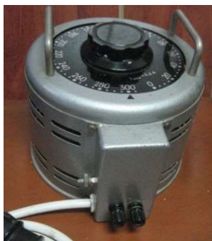
Slika 2.16. Regulacijski transformator sa klizačem
