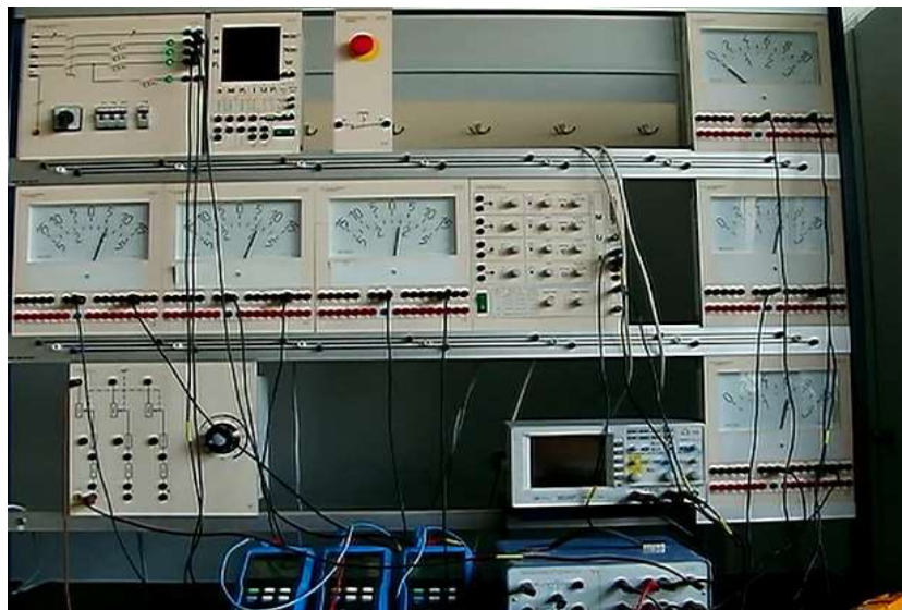
Slika 5.35. Spajanje transformatora u spoj Yz5
